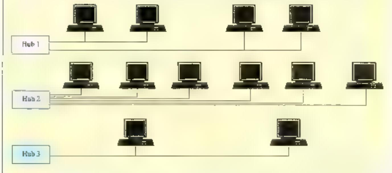
Fig. 3. - Une topologie de réseau « hub/cabotage versatile » isole une partie du réseau, en s'assurant que la panne d'un module n'affectera pas les autres. Plus le nombre de modules est important, plus la tolérance aux pannes du réseau est élevée.
